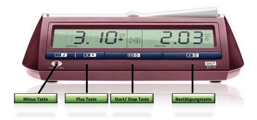
Die DGT 2010 hat einen An- und Ausschaltknopf auf der Unterseite. Mit diesem wird bei mehrfachem Drücken die Uhr abwechselnd ein- und ausgeschaltet. Durch ein Ausschalten der Uhr gehen alle vorhandenen Zeitinformationen verloren und die Uhr geht nach dem erneuten Einschalten in den Ausgangszustand zurück!
